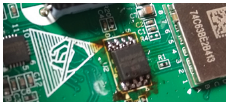
Rys. 15 Przykład śladów po manipulacji przy kości pamięci
